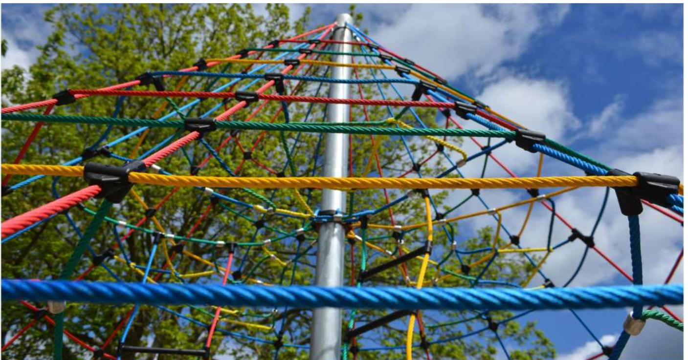
Die **Kletterpyramiden** wurden so konstruiert, dass zumeist nur eine **Fallhöhe von 0,95 m** besteht. Somit können die Pyramiden sogar einfach auf Rasen oder Oberboden aufgestellt werden; ein zusätzlicher Fallschutz ist in der Regel nicht erforderlich. Mit ausgefeilter Seiltechnik; hochwertig, langlebig und wartungsfreundlich. Verschiedene Farbkombinationen lieferbar.
